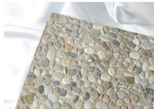
写真8 洗い出し仕上げ
