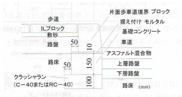
図2 片面歩車道境界ブロックの使用例
